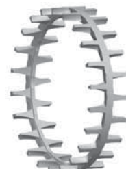
Fig. 8. Colivie monobloc din alamă prelucrată mecanic prin așchiere, cu locașuri deschise la un capăt, cu ghidare pe inelul interior.
