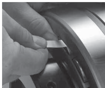
Fig. 18. Măsurarea jocului radial intern înainte de montare.
