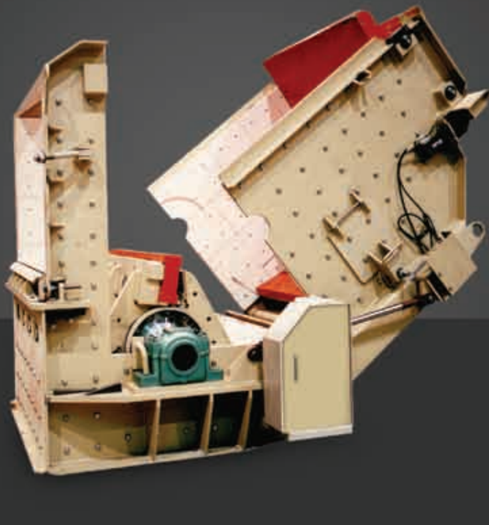
Ansamblu rulment montat în carcasă pentru solicitări grele
